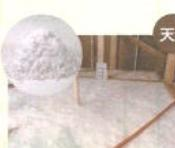
グラスウールを小さな塊状にした吹き込み用断熱材。天井裏のリフォームに最適。
